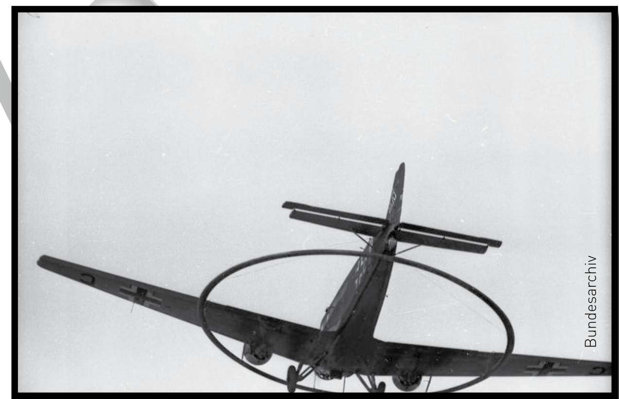
Ju52 MS détecteur et destructeur de mines
